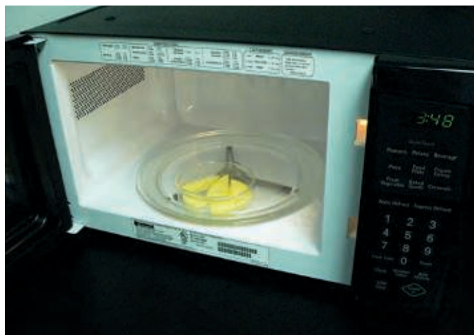
Medición del contenido de materia seca de mango en un horno de microondas
