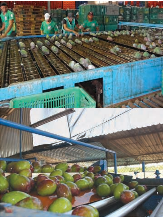
Clasificación de frutos por peso (foto superior) y por tamaño (foto inferior)
