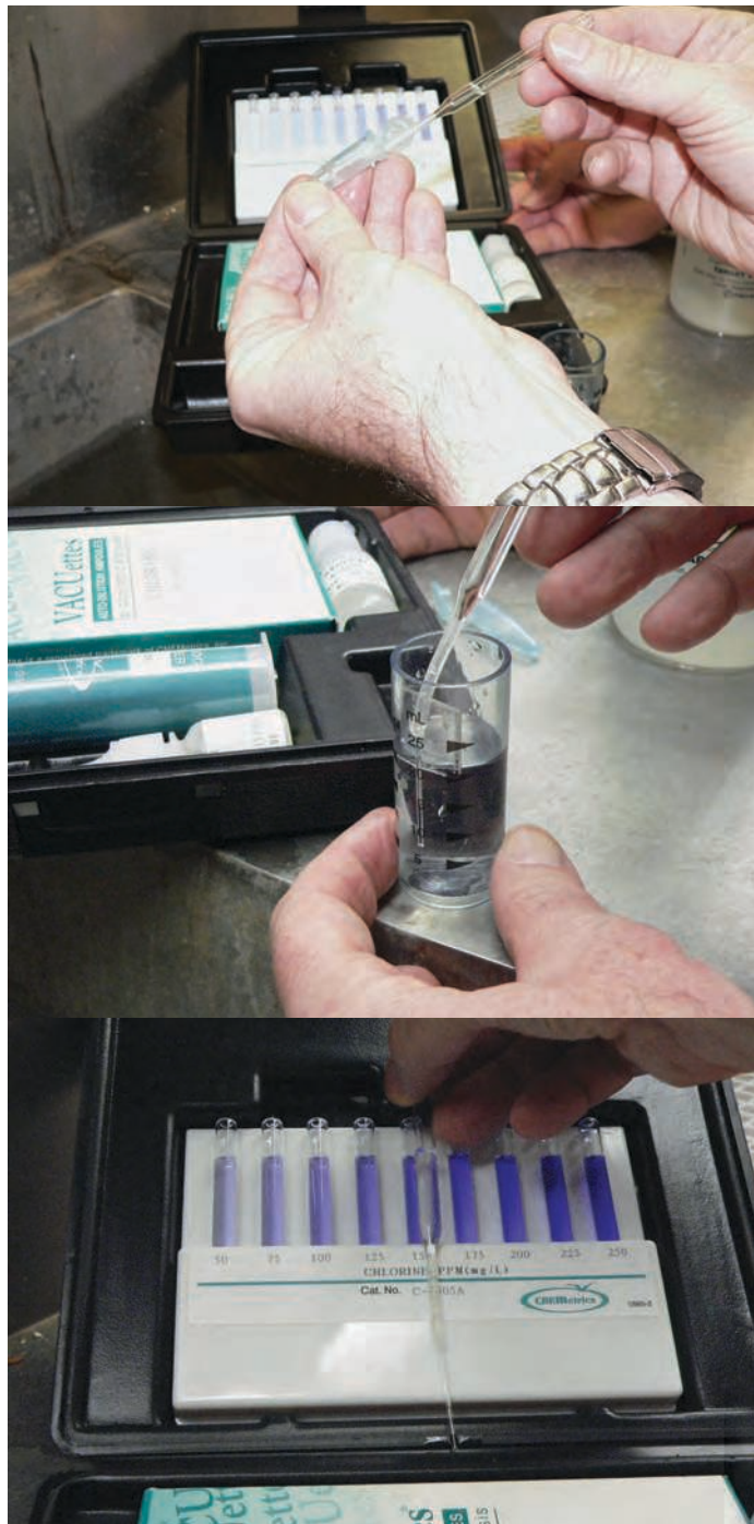
Monitoramento manual dos níveis de cloro na água do tanque
