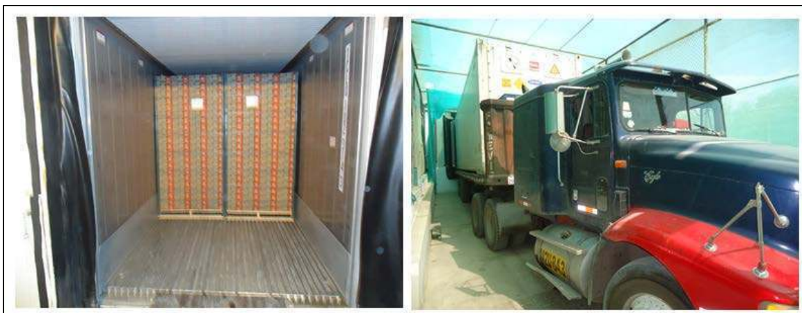
Figura 7: Cargas paletizadas adentro de contenedores ISO intermodales enfriados
