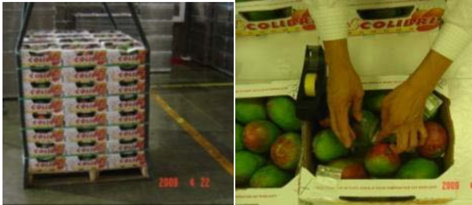
Frutos en pallet y colocación de dosímetros en los frutos
